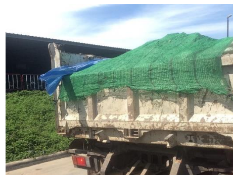
ภาพที่ 2.2-19 การปิดคลุมกระบะรถบรรทุก
